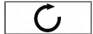
Electropompe cu sens de rotație orar văzut de la gura de tur
